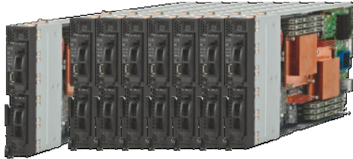
図3 省スペース、省消費電力で多くの仮想サーバを実現するブレードサーバ
