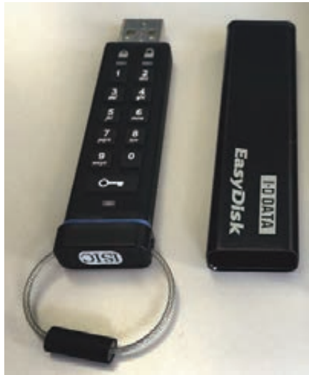
図 11 製品画像。パスワード認証用ボタンを搭載している。
