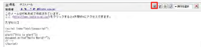
図 HTMLメール受信時の様子。標準でテキスト形式で表示されます。赤枠は、HTML表示に切り替えるボタンです。
